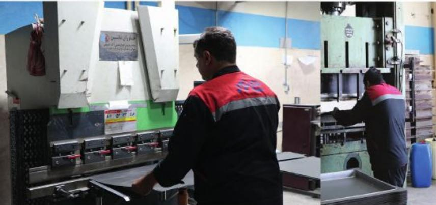
شامل دستگاه های برشکاری، جوش، دستگاه های پرس هیدرولیک متعدد با ظرفیت های مختلف که از آن ها برای شکل دهی قطعات ورق آهن آلومینیوم و ... استفاده می شود. همچنین این واحد مجهز به دستگاه خم BRAKE بوده و کلیه فعالیت های مربوط به خم ها با این دستگاه انجام می شود.
