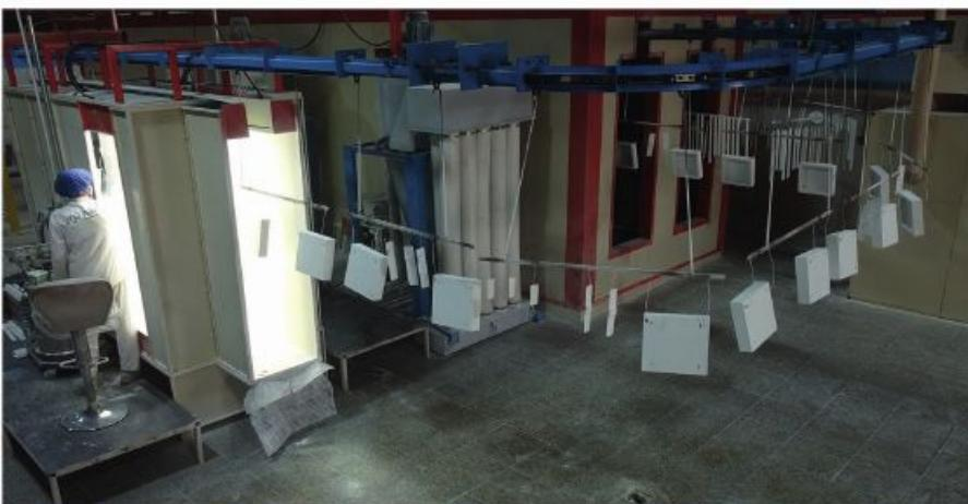
در این واحد قطعات فلزی با رنگ پودری الکترواستاتیک رنگ آمیزی شده سپس به طور پیوسته، قطعات مربوط وارد کوره با دمای یکنواخت شده و در زمان و حرارت تنظیم شده رنگ پودری به عمل می آید.
